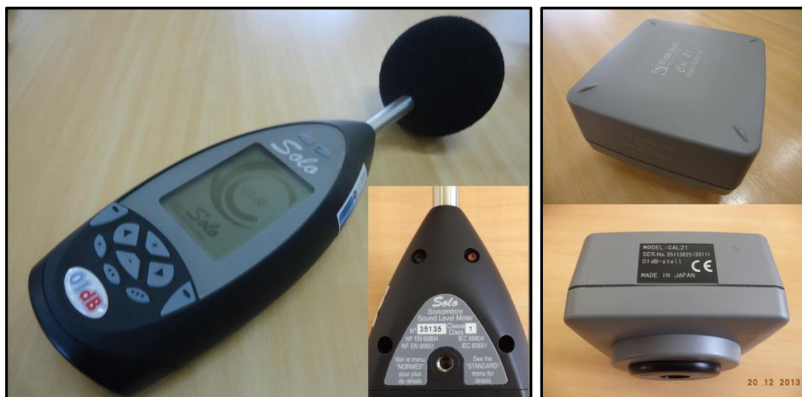
Figura 99 - Medidor integrador de nível sonoro (MINS) e calibrador acústico utilizados.
