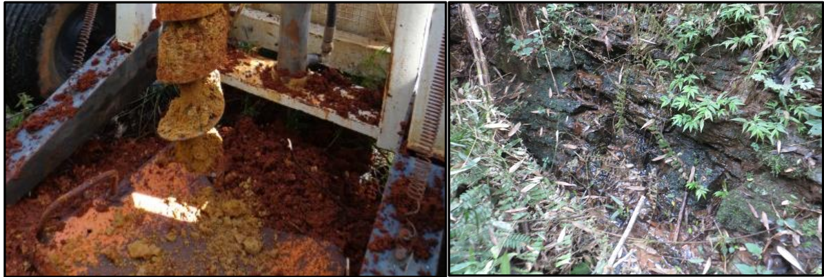
Figura 63 – À esquerda, amostra de fragmentos rochosos do Grupo Itararé na pá do trado e à direita, afloramento rochoso na AID.
