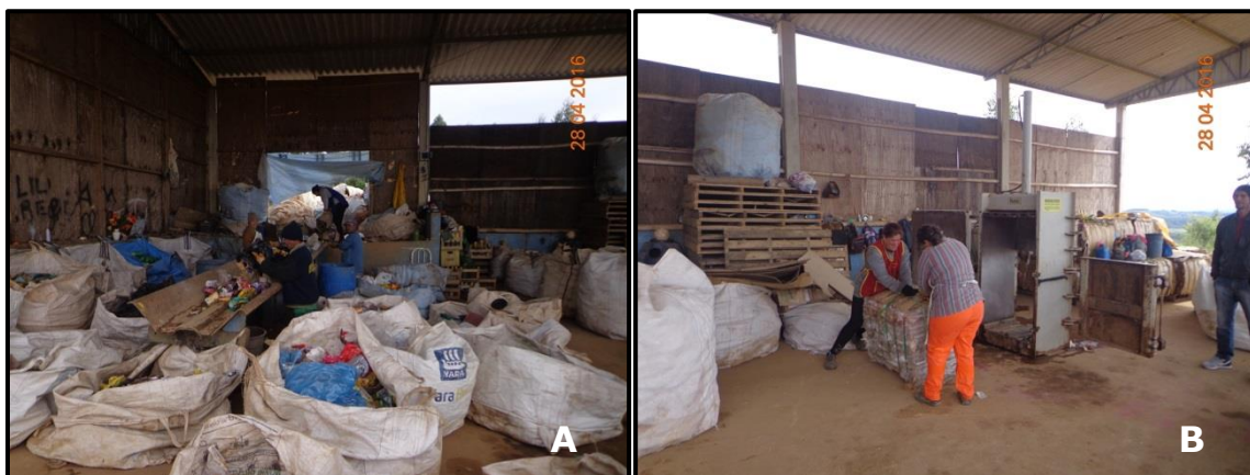
Figura 160 – Triagem (A) e compactação (B) dos materiais recicláveis.
